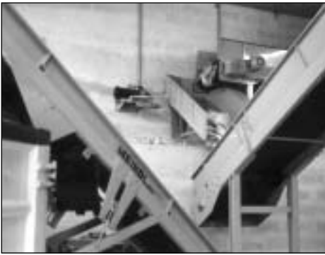
4 Gurtförderbänder auch schwenk- oder verschiebbar, mit Verteilschuren, alles kombinierbar, elektromot. angetrieben
